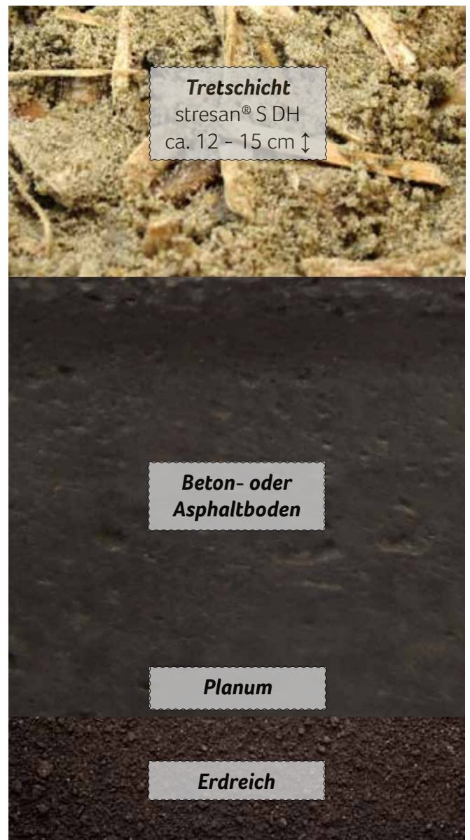
Tretschicht mit Siebgut auf Betonaufbau
